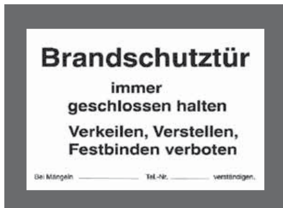
Abb. 2 Hinweisschild für Brandschutztür
