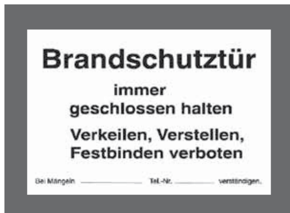
Abb. 2 Hinweisschild für Brandschutztür
