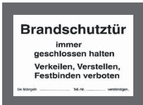
Abb. 2 Hinweisschild für Brandschutztür
