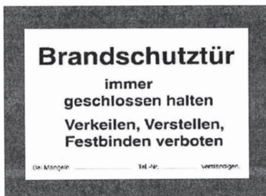
Abb. 2 Hinweisschild für Brandschutztür
